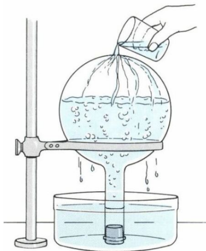
FIGURE 7 – On verse de l'eau froide sur un flacon contenant de l'eau très chaude : l'eau se met à bouillir
