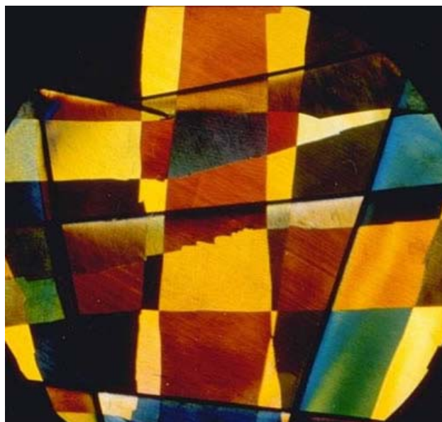
Observation en lumière polarisée des interférences créées par un milieu biréfringent.
