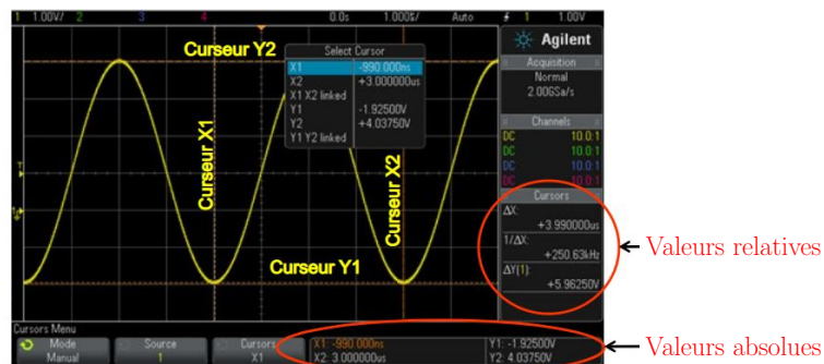
Figure 35 – Exemple de mesures avec les curseurs
