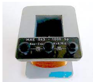
Figure 62 – Exemple de bobine d'auto-induction disponible en TP
