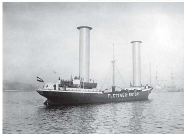
FIGURE 10 – Voilier Flettener fonctionnant grâce à l'effet Magnus. Expliquer.
