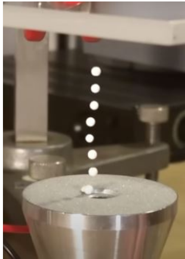
Figure 1 – Billes de polystyrène en lévitation dans une onde stationnaire ultrasonore
