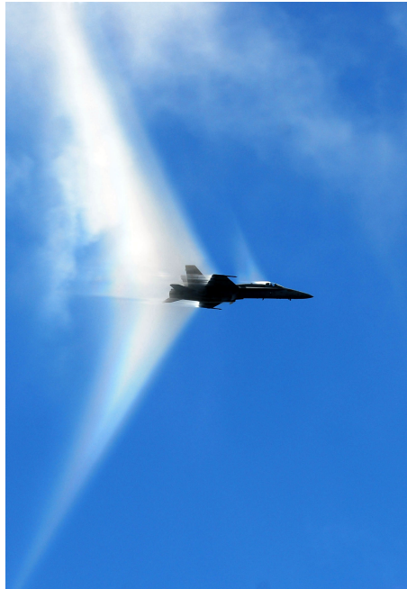
FIGURE 18 – Onde de choc sur un F18
