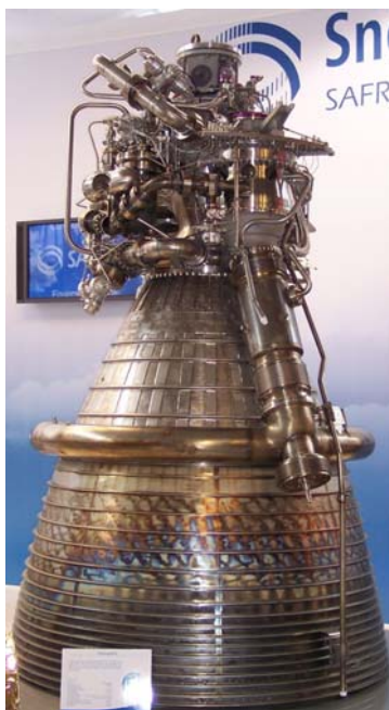
Tuyère de Laval équipant un moteur Vulcain.
