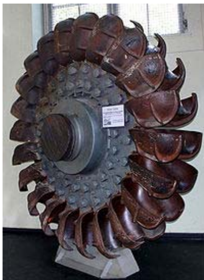
Roue à augets d'une turbine Pelton
