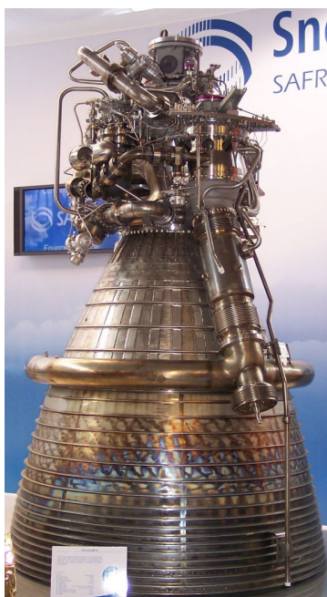
Tuyère de Laval équipant un moteur Vulcain.
