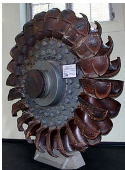
Roue à augets d'une turbine Pelton
