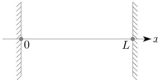
Figure 24 – Cavité électromagnétique 1D
