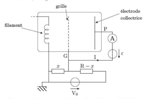
La grille est portée au potentiel électrique V<sub>G</sub> positif obtenu grâce à un circuit contenant deux résistances variables (x et R - x, avec x compris entre 0 et R) et un générateur délivrant une tension V<sub>0</sub>.
