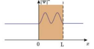
On considère un flux de quantons de masse m et d'énergie E en incidence, depuis  $x \to -\infty$ , sur une barrière de potentiel (énergie potentielle  $V(x) = V_0 > 0$  pour  $x \in [0; L]$  et nulle sinon).
