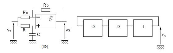
Dans ce montage, (D) est un déphaseur et (I) est un ampli inverseur de gain G.
