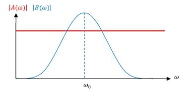
⇒ La fréquence d'accrochage est celle du résonateur (circuit de rétroaction)
