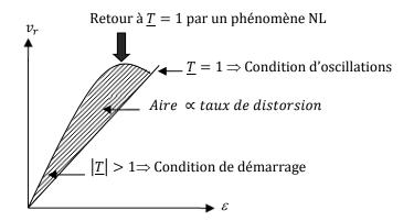
Pour l'oscillateur à Pont de Wien, la condition  $|\underline{A},\underline{B}|$   $\Big|_{\omega=\omega_{osc}}>1$  se traduit par  $A>\frac{1}{Q}$
