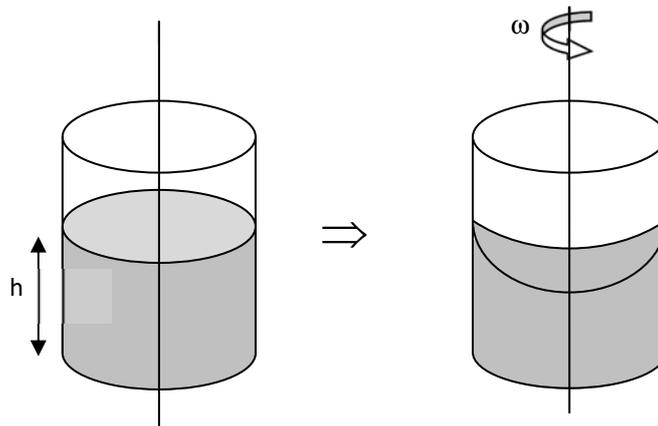
D'après ce qui précède, on a :  $\mu \vec{g} - \mu \vec{a}_e = \overrightarrow{grad}(P)$  avec  $\vec{a}_e = -\omega^2 r \vec{e}_r$
