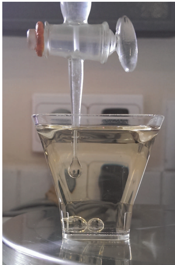
FIGURE 6 – Expérience de la pesée de la goutte
